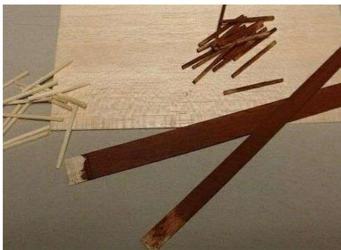
Beides habe ich erst mal mit Holzbeize behandelt. Die Streichhölzer habe ich in entsprechenden Längen gebracht, wie sie für den Zusammenbau gebraucht werden. Als Montagehilfe habe ich mir einfach mit einem Dreieckslineal einen Winkel auf einer Holzplatte aufgezeichnet. Entlang der Linien wurden dann Stecknadeln senkrecht in das Holz leicht eingeschlagen.
