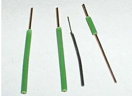
Jeder Modellbahner hat in seinem Bereich Drahtlitzen griffbereit. Sei es um Schaltungen, Weichen, Signale oder einfach nur Beleuchtungen anzuschließen. Aber mit ein paar Millimeter dieser Drahtlitzen lassen sich noch andere Dinge für den Modellbahner herstellen. Z.B. Auspuffanlagen für jede Art von Fahrzeugen. Sei es nun die großen und kräftigen Auspuffrohre von LKW's, Site-Pipes für Sportwagen oder Auspuffanlagen für ganz normale Fahrzeuge.
