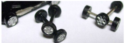
Räderwerk: Fest angegossen bei Tsugawa (links), mit Profil bei Tomytec (mitte) und mit Stahlachse bei Kawai (rechts).
